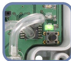
Rys. 16 Sygnalizacja komunikacji Power / Modbus
