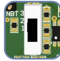
Fig. 5 Keuzeschakelaar voor analoge uitgang
