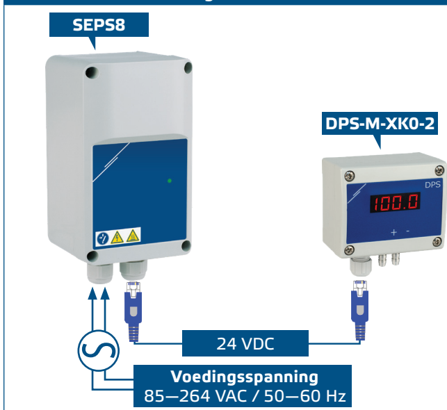
Voorbeeld 1: Aansluiting via de RJ45 connector
