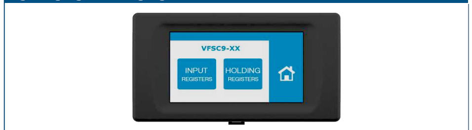
Fig. 5 Ingang en holding registers selectie
