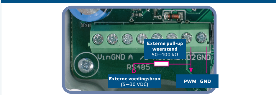
Fig. 6 PWM (Open collector) aansluiting
