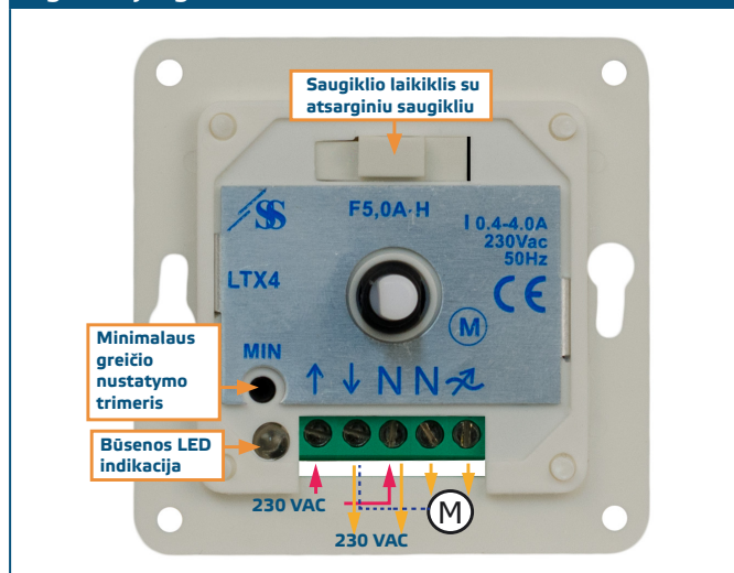
Fig. 1 Pajungimo schema
