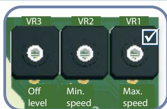
**Fig.7 Regolatore di velocità minima**
