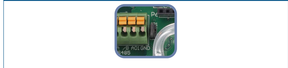
Fig. 5 Ponticello della resistenza pull-up collegato
