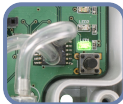
Fig. 16 Indicazione di comunicazione Power / Modbus
