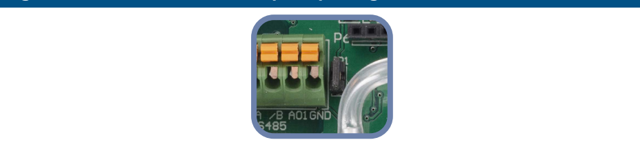
Fig. 5 Ponticello della resistenza pull-up collegato
