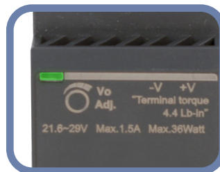
Fig. 5 Indicazione di alimentazione OK
