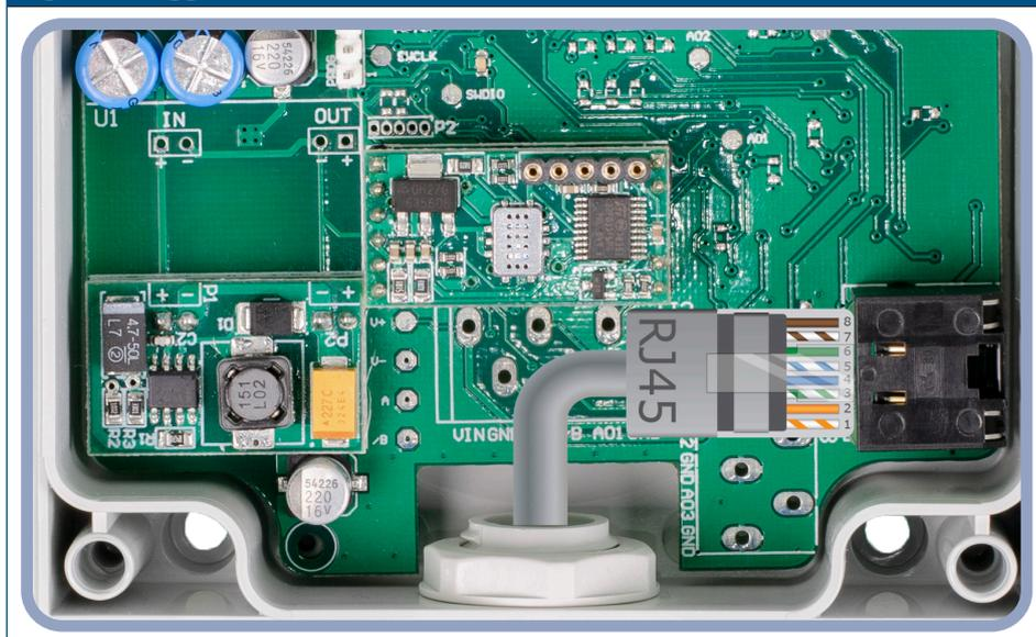
3. Chiudere il coperchio e fissarlo con le viti. Stringere il pressacavo per mantenere il grado di protezione IP del contenitore.
