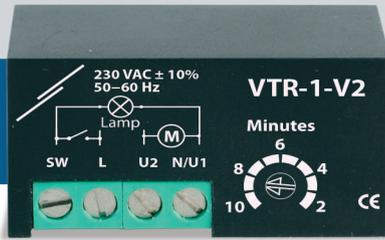
Il VTR-1-V2 è un modulo timer elettronico controllato da triac per ventilatori che ventilano piccoli spazi come gabinetti e bagni. Il ventilatore si attiva 1,5 s dopo l'accensione delle luci. Quando le luci sono spente, il ventilatore viene disattivato dopo un ritardo regolabile tra 2 e 10 minuti.
