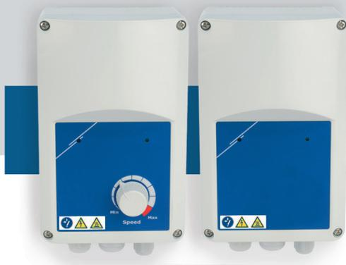
I VFSC9 sono regolatori elettronici di velocità per ventilatori con motori a induzione monofase (110–240 VAC / 50–60 Hz). Hanno un ingresso analogico selezionabile (0–10 VDC / 0–20 mA / PWM) e comunicazione Modbus RTU. Rispetto al controllo dell'angolo di fase (regolatori di velocità per ventilatori Triac), la serie VFSC9 genera un segnale di uscita con una forma sinusoidale quasi perfetta, mentre l'inquinamento EMC rimane limitato, il fattore di potenza supera 95 %. {2}
