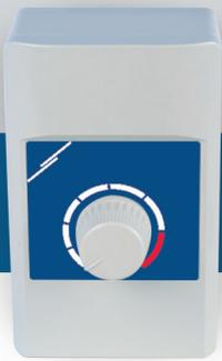
L'USV-8/010-PA è un potenziometro attivo (tensione di alimentazione 85–264 VAC / 50–60 Hz) con uscita 0–10 VDC / 0–20 mA / PWM ed è sviluppato per controllare ventilatori/motori EC o altri dispositivi che richiedono un segnale di ingresso 0–10 VDC/0–20 mA/PWM.
