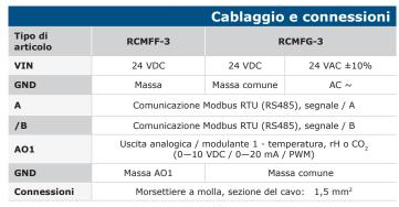
**Attenzione!** La versione -F del prodotto non è adatta per la connessione a 3 fili. Ha masse separate per l'alimentazione e l'uscita analogica. Il collegamento di entrambe le Masse insieme potrebbe causare misurazioni errate. Sono necessari almeno 4 fili per collegare i sensori di tipo F.
