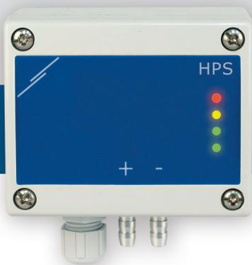
Le serie HPS-M--LP sono trasmettitori di pressione differenziale (-125—125 Pa), che sono dotati di un trasduttore di pressione completamente digitale progettato per una vasta gamma di applicazioni. La lettura della velocità dell'aria è disponibile collegando un set esterno di connessione del tubo di Pitot. Sono forniti Power over Modbus e i parametri sono accessibili tramite Modbus RTU (software 3SModbus o Sensistant).
