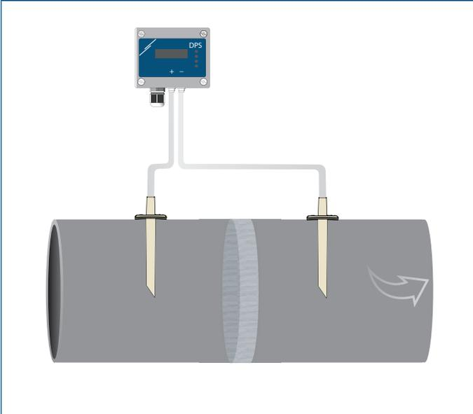
**Applicazione 2:** Misurazione del flusso volumetrico fornito  $\backslash$  [m<sup>3</sup>/h] o della velocità dell'aria  $\backslash$  [m/s] utilizzando il set di collegamento del tubo di Pitot PSET-PT
