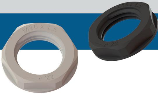
CN-XX sono dadi esagonali con filettatura metrica destinati al serraggio sicuro dei pressacavi serie CG Sentera di dimensioni adeguate. Garantiscono la tenuta e la terminazione e fungono da elemento antistrappo per il cavo.
