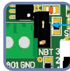
Fig. 7 Cavalier de résistance de bus réseau
