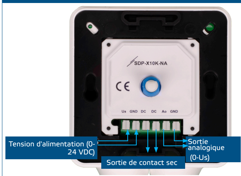
Fig. 1 Câblage et raccordements
