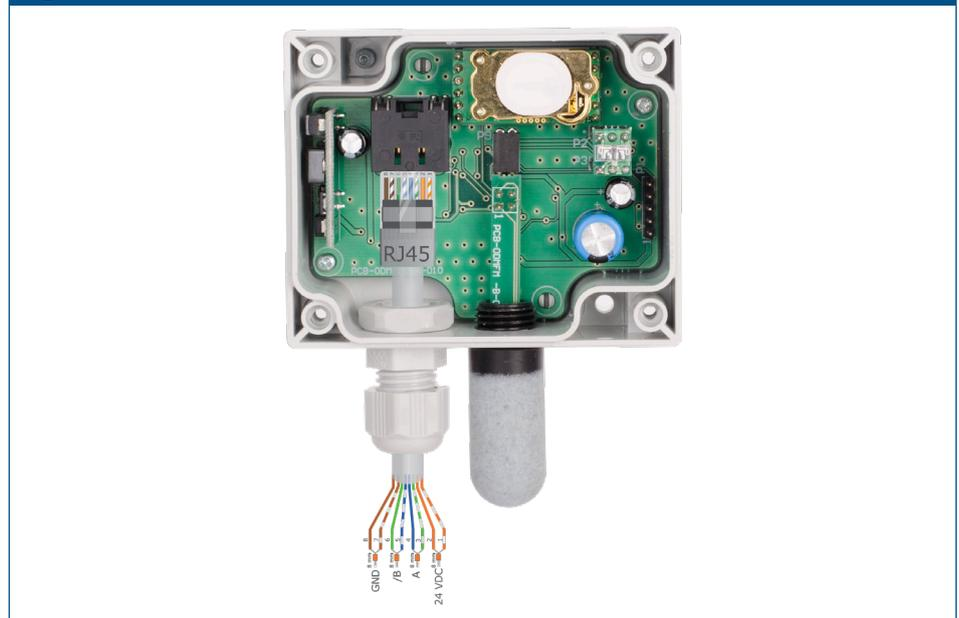
4. Fermez le boîtier et fixez-le avec les vis. Serrez le presse-étoupe pour conserver l'indice IP du boîtier.
