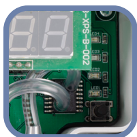
Fig. 8 Commutateur tactile et indications d'étalonnage du capteur et de réinitialisation du registre Modbus
