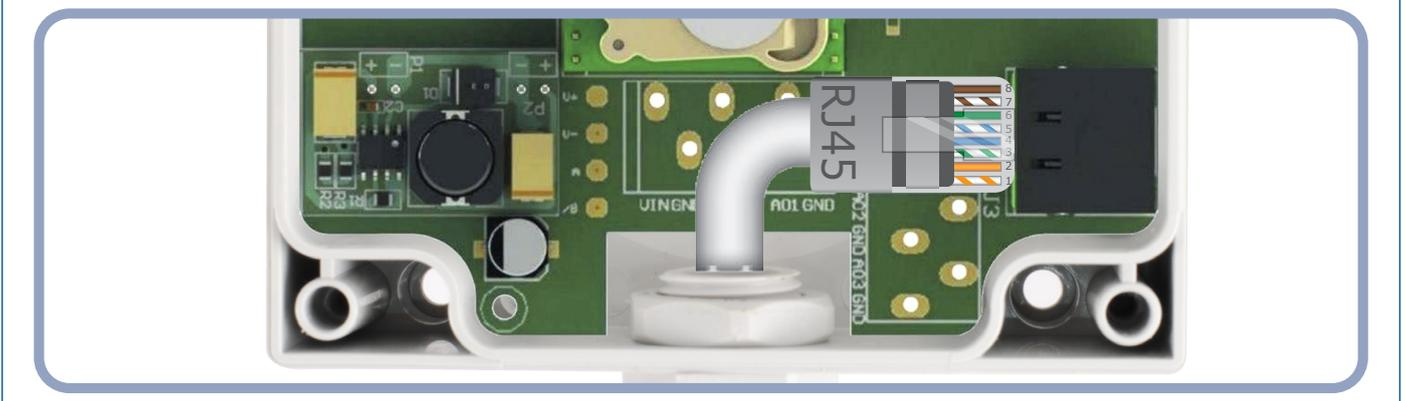
3. Fermez le boîtier et fixez-le avec les vis. Serrez le presse-étoupe pour conserver l'indice IP du boîtier.
