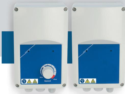
Les VFSC9 sont des variateurs électroniques pour les moteurs asynchrones monophasés (110–240 VAC / 50–60 Hz). Ils ont une entrée analogique sélectionnable (0–10 VDC / 0–20 mA / PWM) ainsi que la communication Modbus RTU. Par rapport au contrôle d'angle de phase (les variateurs de vitesse à Triac), la série VFSC9 génère un signal de sortie avec une forme sinusoïdale presque parfaite, tandis que la pollution EMC reste extrêmement limitée et l'efficacité est plus de 95%.
