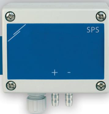
Les régulateurs de pression différentielle SPSP contrôlent les ventilateurs EC, ou les variateurs de fréquence. Ils sont prévus de communication Modbus RTU et d'une sortie analogique / digitale. Les régulateurs SPSP disposent une régulation PI, point de consigne et facteur K. Ils sont compensés en température et offrent un degré élevé de fiabilité et de précision.
