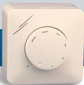
Ces potentiomètres contrôlent des ventilateurs équipés avec un moteur EC. Ils conviennent aux applications où un signal de contrôle DC est requis. Ils ont une enceinte imperméable à l'eau et ils sont adaptés pour le montage encastré ainsi que pour le montage en saillie. Il existe deux versions avec et sans position "OFF".
