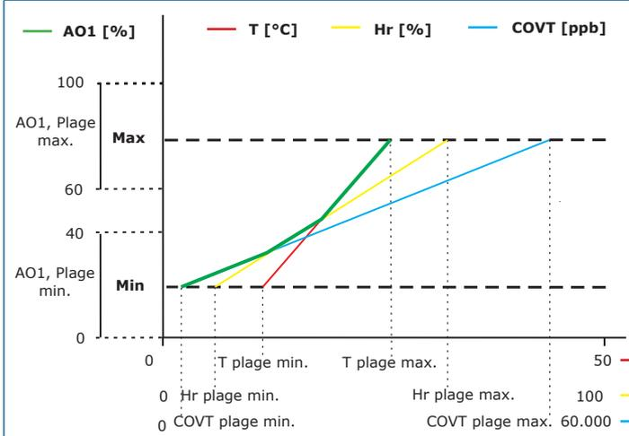
**Note:** La mesure du COVT renverra 0 ppb pendant le temps de préchauffage. La sortie change automatiquement en fonction de la plus élevée des valeurs T, Hr ou COVT, c'est-à-dire que la plus élevée des trois valeurs contrôle la sortie. Voir la ligne verte dans le diagramme opérationnel ci-dessus. Un ou plusieurs capteurs peuvent être désactivés. Par exemple: il est également possible de contrôler la sortie uniquement sur la base des valeurs COVT mesurées.
