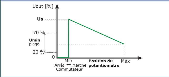
Position d'arrêt désactivée: tension d'alimentation connectée à L1 et N
