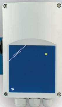
L'EVS-1-XX-DM est un variateurs / régulateurs électronique qui contrôle la vitesse des moteurs monophasés (230 VAC / 50–60 Hz) contrôlables par tension. Le régulateur est équipé de communication modbus RTU et fournit une large gamme de fonctionnalités : les options de télécommande, «off-level» ajustable, niveau min. et max. du sortie analogique ajustable et fonctionnement du moteur limitée dans le temps lancée par un signal logique ou par commutation externe.
