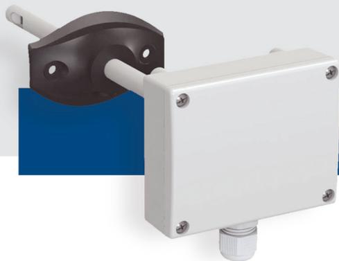
Les séries de DXH sont des transmetteurs / commutateurs qui mesurent l'humidité relative dans des conduits. Quatre plages prédéfinies fournissent des fenêtres de mesure idéales avec supplémentaire une plage définissable par l'utilisateur. Le capteur digital mis en œuvre, est auto calibrant et ne nécessite aucun entretien. Ces capteurs sont équipés de communication Modbus RTU (RS485) et ils ont une sortie analogique.
