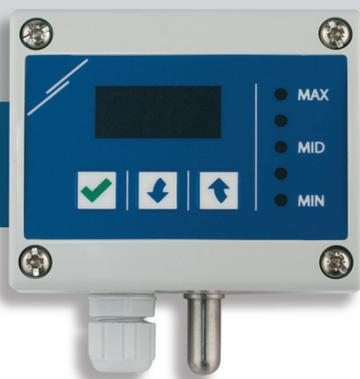
Les séries DTAP sont des contrôleurs universels programmables. Ils ont une entrée de température et / ou analogique (0–10 VCC / 0–20 mA / PWM) et fournissent une sortie analogique proportionnelle avec deux points de consigne, une lecture numérique et une indication de sortie LED. Le contrôleur DTAP permet la programmation des points de consigne pour les entrées et les sorties.
