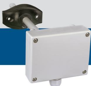
Les séries DSTHM-2 sont des transmetteurs de gaine combinés qui mesurent la température et l'humidité relative. Sur la base des mesures de la température et de l'humidité relative, le point de rosée est calculé. Tous les paramètres sont accessibles via Modbus RTU.
