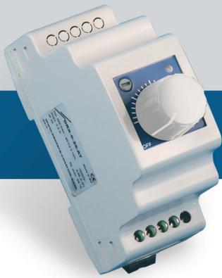
Les variateurs de la série DRY sont des régulateurs de vitesse pour ventilateurs AC avec moteur monophasé contrôlable en tension. En tournant le bouton rotatif sur le panneau avant, la tension régulée peut être réglée de faible à élevée. En tournant complètement le bouton vers la gauche (position Off), le moteur peut être éteint. Le potentiomètre interne permet d'affiner la vitesse minimale pour l'application. Le boîtier est adapté au montage sur rail DIN.
