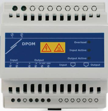
Module d'alimentation de 24 VDC pour rail DIN avec un répéteur de communication Modbus RTU, entièrement isolé avec indication de côté de transmission. Le DPOM8 peut aussi être utilisé comme alimentation pour les capteurs Sentera.
