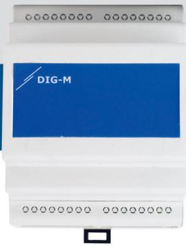
La passerelle Internet DIG-M-2 est un appareil destiné à connecter des appareils Sentera à Internet afin de les surveiller et de les configurer via SenteraWeb. L'appareil dispose de 2 canaux Modbus RTU: un canal esclave auquel les appareils Sentera sont connectés et un canal maître pour connecter un contrôleur maître ou un système GTB. Il peut être connecté à Internet via Wi-Fi ou Ethernet.
