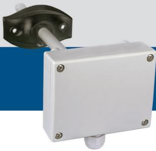
Les DCCOX-R sont des capteurs de conduit intelligents dotés de plages réglables de température, d'humidité relative et de CO / NO<sub>2</sub>. L'algorithme utilisé contrôle une seule sortie analogique/modulante basée sur les valeurs mesurées de T, Hr et CO / NO<sub>2</sub>, qui peut être utilisée pour contrôler directement un ventilateur EC, un variateur de vitesse AC ou un actionneur de registre. Tous les paramètres sont accessibles via Modbus RTU.
