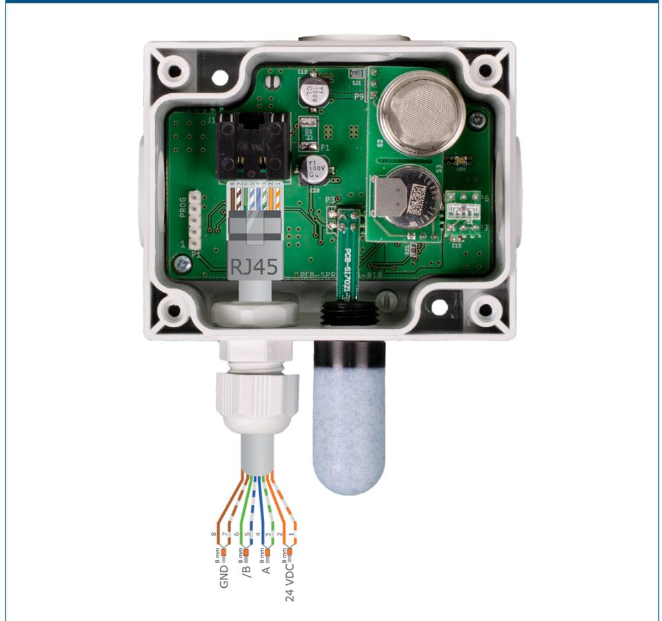
4. Cierre el panel fijándolo con los tornillos. Apriete los prensaestopas para garantizar el grado de protección IP del dispositivo.
