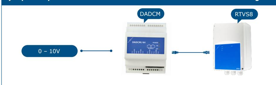
**Ejemplo de aplicación 4: Modo automático - control a través de un potenciómetro digital**
