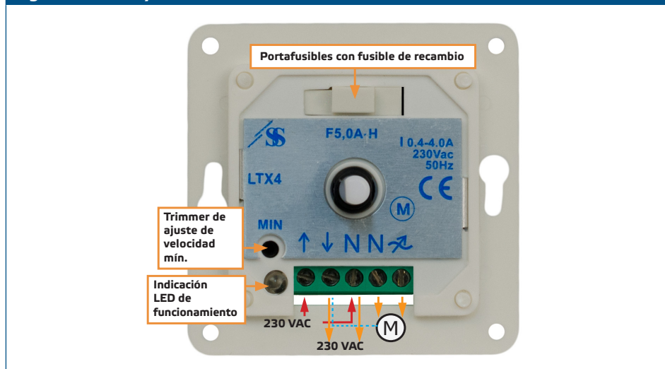
Fig. 1 Cableado y conexiones
