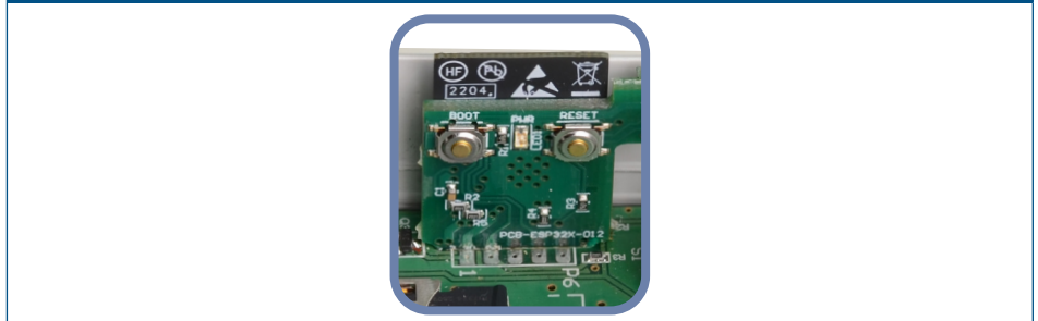
Fig. 8 Interruptor táctil de reinicio de Wi-Fi
