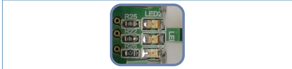
Fig. 5 Indicación de LED de conexión a Internet
