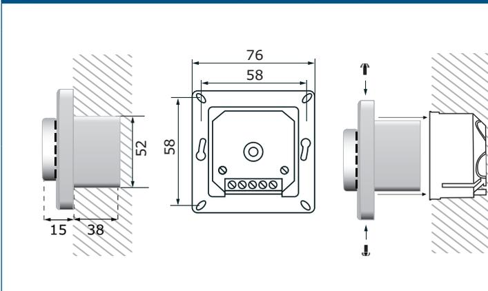
**Fig. 3 Posición de montaje**
