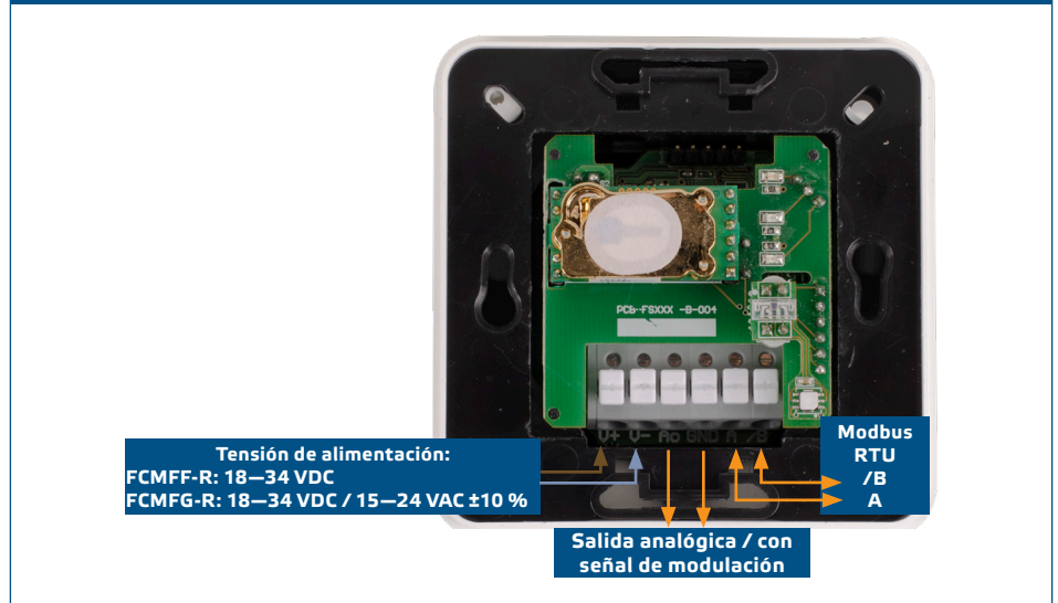
Fig. 1 Cableado y conexiones
