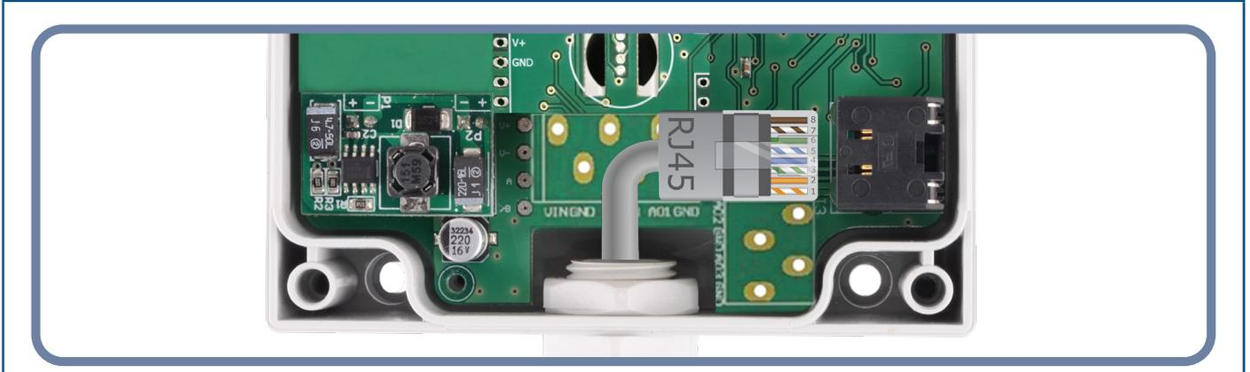
3. Cierre el panel frontal y fíjelo con los tornillos. Apriete los prensaestopas para garantizar el grado de protección IP del dispositivo.
