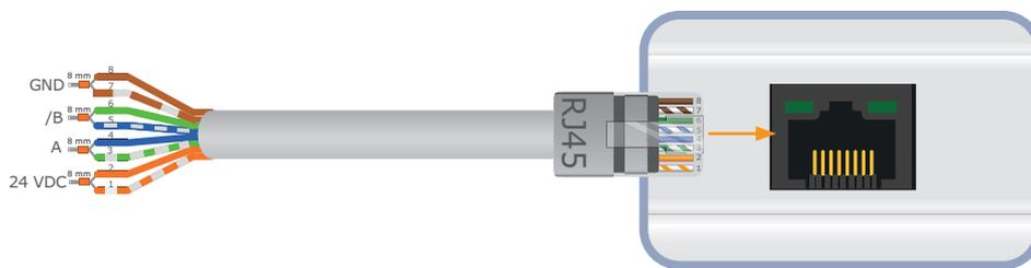
4. Enganche el conector RJ45 al cable (para la fuente de alimentación de 24 VDC y la comunicación Modbus RTU) y enchúfelo al conector RJ45 hembra, (consulte la **Fig. 3b**).
