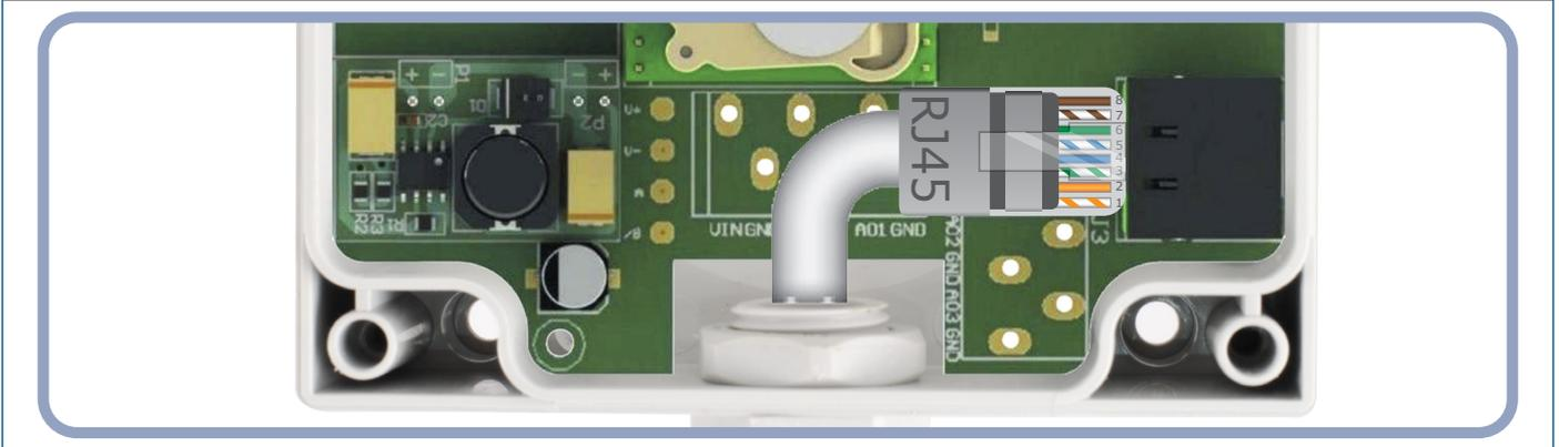
3. Cierre el panel fijándolo con los tornillos. Apriete los prensaestopas para garantizar el grado de protección IP del dispositivo.
