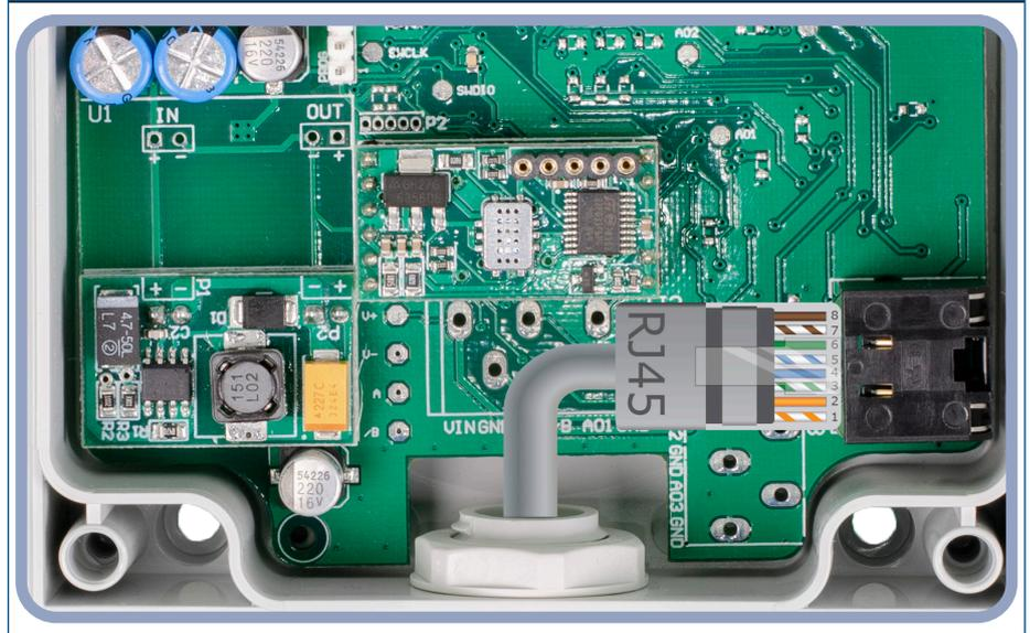
3. Cierre el panel fijándolo con los tornillos. Apriete los prensaestopas para garantizar el grado de protección IP del dispositivo.
