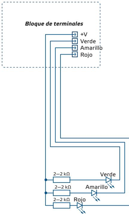
Fig. 4b Conexión de relés LED externos
