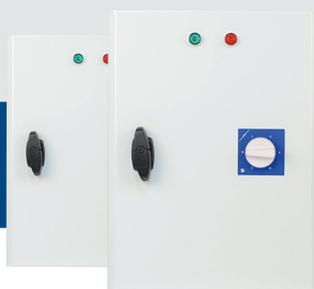
Las series STTA4 incluyen reguladores de la velocidad de rotación de ventiladores con motores trifásicos, regulables por tensión, a través de la variación de la tensión de salida. Estos dispositivos son equipados con autotransformadores y regulan la velocidad manualmente en cinco escalones (posiciones). Además, cuentan con un interruptor termomagnético para protección del motor, contactos para 'start / stop' remoto, así como salida de alarma 230 VAC.
