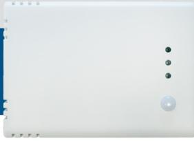
La serie RSMFH-3 son transmisores de ambiente multifuncionales que miden los niveles de concentración de CO<sub>2</sub>, la temperatura, la humedad relativa y la luz ambiental. Disponen de tres salidas analógicas/modulantes para temperatura, humedad relativa y CO<sub>2</sub> y necesitan una fuente de alimentación 24 VDC. A través de Modbus RTU, todos los parámetros son accesibles.
