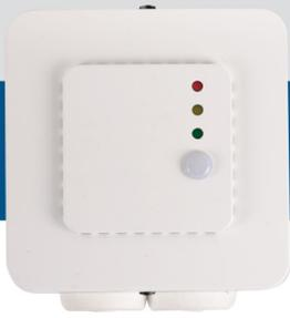
Las series FCVC8-R incluyen sensores inteligentes, que miden total de compuestos orgánicos volátiles (TCOV), temperatura (T) y humedad relativa (HR). Su algoritmo controla una salida analógica / con señal de modulación según las mediciones de TCOV, temperatura y humedad, que se puede usar para control directo de ventiladores EC, reguladores de velocidad de ventiladores AC y actuadores para válvulas o compuertas. Todos los parámetros son accesibles a través de la comunicación Modbus RTU.
