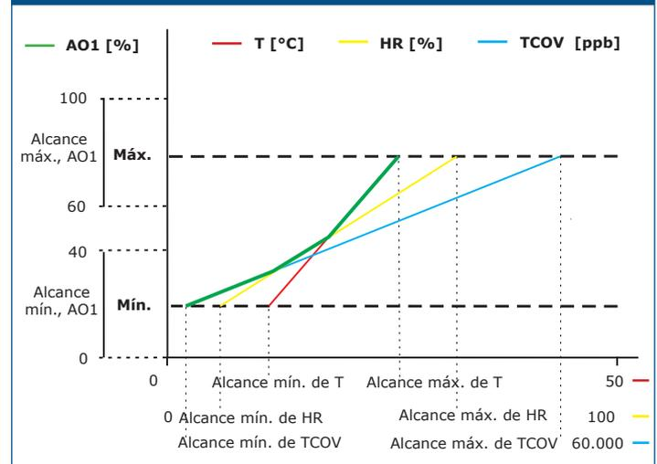
**NOTA:** Las mediciones de TCOV permanecerán en 0 ppb durante el tiempo de precalentamiento. La salida se cambiará automáticamente, dependiendo del valor más alto de TCOV, T o HR. Esto es, el valor más alto de los tres controlará la salida. Véase la línea verde del 'Diagrama de funcionamiento'. Se pueden desactivar una o varias mediciones. Por ejemplo, es posible controlar la salida solamente en función de las mediciones de TCOV.
